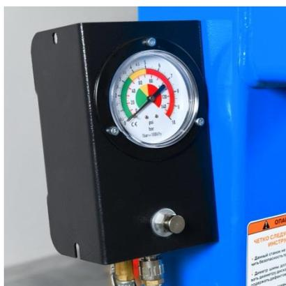
Шиномонтажный станок КС-302А оснащен стационарным блоком подкачки.
