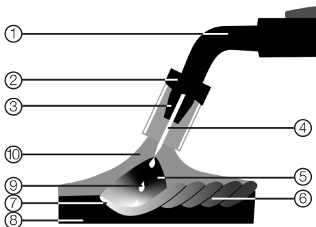
Рис. 24. Полуавтоматическая сварка MIG/MAG.
