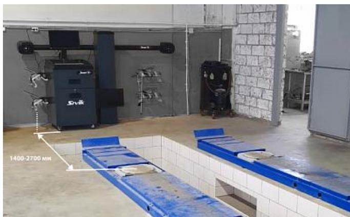
Установка стенда на расстоянии 1400-2700 мм от колонны до центра поворотных кругов
