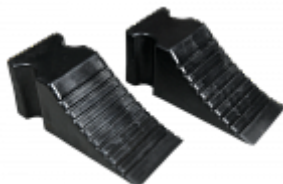
Упор педали тормоза, противооткатные упоры
